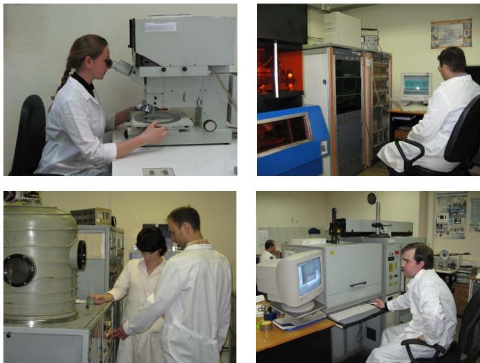
Рис. 3.2. Рабочие места в ЗАО НПП «Салют-27», на которых проходят практику студенты ННГУ (по часовой стрелке): измерение геометрических размеров элементов на фотошаблонах; генерация изображений для изготовления фотошаблонов; лазерная обработка микроплат; изготовление интегральных микросхем и термовакuumное напыление резистивных микрослоев
